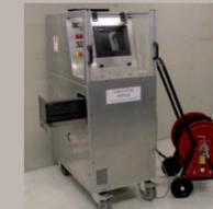
Banc "orfèvre" pour contrôle étanchéité vannes sur circuit réacteur REP EDF
