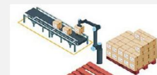
Le **Soft Pally** de Rocketfarm est un logiciel de palettisation facile d'accès et très flexible qui permet aux opérateurs de programmer de nouveaux modèles de palettisation en quelques minutes et de prolonger la longévité du robot via l'optimisation de ses trajectoires de mouvement.
