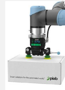
Le **piCOBOT**® de PIAB est un préhenseur à vide doté de commandes intégrées, de grands indicateurs d'état et d'un affichage convivial. Certifié par Universal Robots, il se monte directement sur le bras du robot UR.
