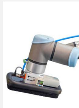
Les **caissons à vide carbone** de COVAL, Série CVGC, répondent parfaitement aux contraintes de poids, de flexibilité et de sécurité des applications de robots collaboratifs pour la manipulation de cartons, très communs dans le secteur pharmaceutique.
