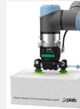
Le **piCOBOT**® de PIAB est un éjecteur à vide doté de commandes intégrées, de grands indicateurs d'état visuels et d'un affichage convivial. Certifié par Universal Robots, il se monte directement sur le bras du robot UR (ISO-9409-1-50-M6).
