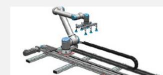
Le **MAD Controller**, créé par notre partenaire Nutai, est un logiciel URCap qui permet de contrôler un ou plusieurs contrôleurs d'axe externes via un cobot UR. Particulièrement utile dans l'industrie agroalimentaire, il est fréquemment utilisé pour les opérations d'emballage, de palettisation ou de transfert de produits d'une ligne à l'autre.
