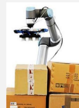
Le **dépalettiseur** de Photoneo est une solution de dépalettisation universelle qui peut être déployée dans toutes les applications qui nécessitent le déchargement de boîtes à partir de palettes, avec des scanners de visions guidés par IA.
