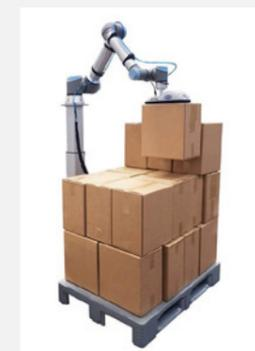
Le **Robot Set FXCB** de Schmalz se distingue par sa facilité d'utilisation. Il est idéal pour la manipulation de pièces dans le domaine de l'intralogistique à l'aide d'un préhenseur à vide pneumatique.
