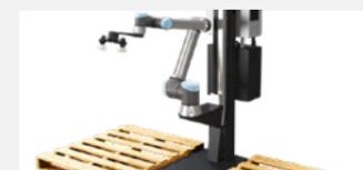
Le **Kit de palettisation** de Robotiq génère et optimise automatiquement toutes les trajectoires et tous les mouvements du robot. Il permet d'installer le cobot entre deux zones de palettisation, sur un axe vertical, afin de prendre de la hauteur au fur et à mesure du remplissage des palettes.
