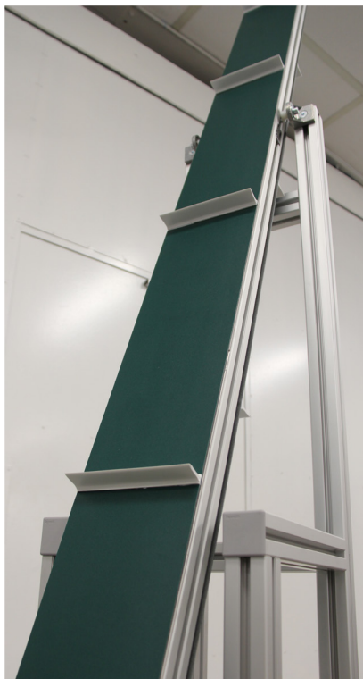
Tasseaux montés sur convoyeur élévateur
