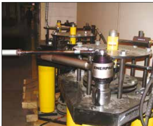
◀ Multiplicateur de couple à bras de réaction Enerpac E393 utilisé pour exercer manuellement un couple de serrage sur des boulons allant jusqu'à 4300 Nm.
